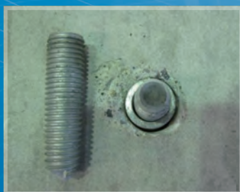
引張試験後の破壊状況
